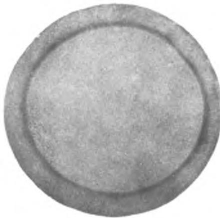
Рис. 7. Макроструктура шейки вала с поверхностной высокочастотной закалкой.
