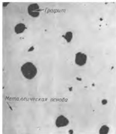
Рис. 32. Шаровидный графит в высокопрочных чугунах.  $\times 200$ .
