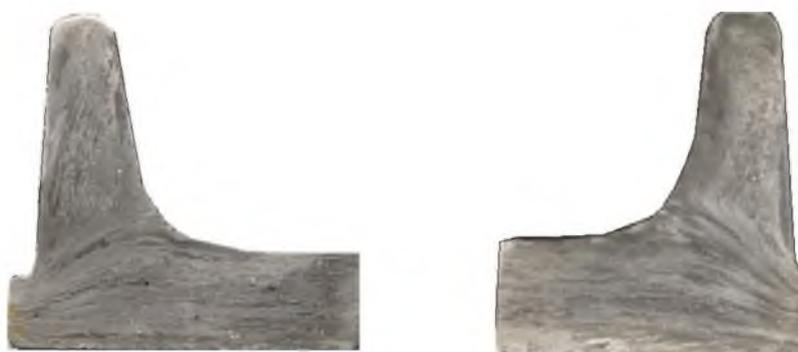
Рис. 14. Макроструктура штампованной поковки. Макроструктура неудовлетворительная. Наблюдаем «прострел».
