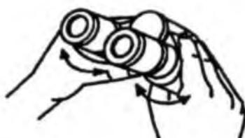
Рис. 17. Схема установки удобного расстояния между окулярами
