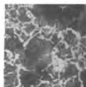
Рис. 5.10. Микроструктура стали 55ПП с недопустимо крупным зерном. × 100.
