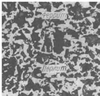
Рис. 25. Микроструктура стали с содержанием углерода 0,4%.  $\times 200$ .
