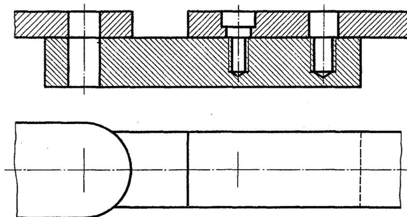
2. Выполнить чертежи каждой детали в отдельности. Нанести обозначения, учитывая требования ГОСТ 2.409-74:
