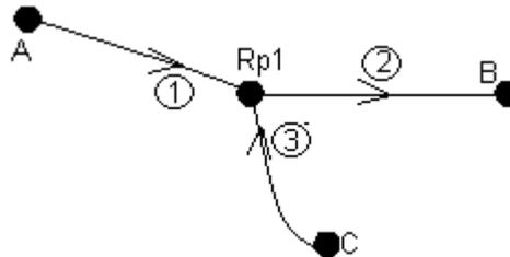
16. Уравнять параметрическим способом результаты нивелирования в сети. Схема сети на рис., исходные данные в табл. (i-номер варианта).
