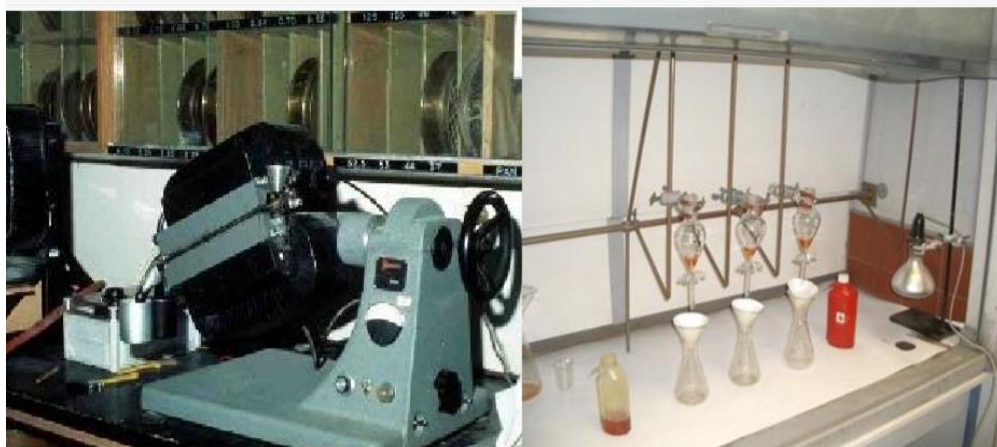
Рис. 2 Примеры приборной базы для выделения акцессориев: электромагнитные сепараторы (левый фрагмент рисунка) и стенд для выделения минералов в тяжелых жидкостях (правый фрагмент рисунка)
