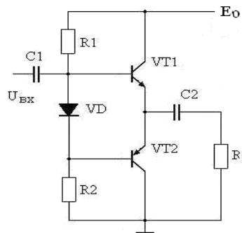
Рис.2. Усилитель мощности
