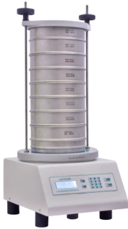
Рис.1 Электромагнитный ситовой шейкер
