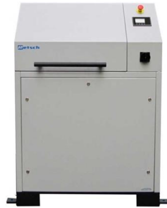
Рис.2 Вибрационная дисковая мельница
