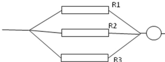
28. Даны значения сопротивлений  $R_2$  Ом и  $R_3$  Ом. Сила тока, текущего через сопротивление  $R_2$ , равна  $I_2$  А, сила тока, текущего через амперметр, равна  $I$  А. Найти значение сопротивления  $R_1$ .
