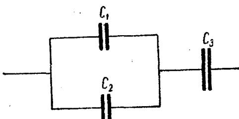
14. Найти емкость  $C$  мкФ системы конденсаторов. Емкость каждого конденсатора равна  $C_1, C_2, C_3$  мкФ.
