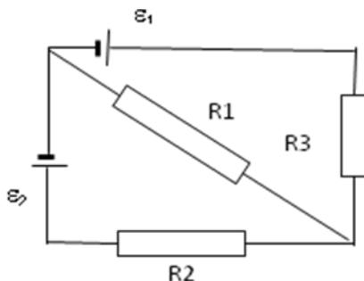
33. Найти силу тока во всех участках цепи  $I_1$ ,  $I_2$ ,  $I_3$  ампер. При этом известны следующие величины: ЭДС<sub>1</sub> В, ЭДС<sub>2</sub> В,  $R_1$  Ом,  $R_2$  Ом,  $R_3$  Ом. Внутреннее сопротивление элементов равно нулю.
