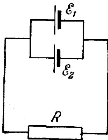
27. На схеме сопротивление  $R$  Ом, два элемента с одинаковой ЭДС. Внутренние сопротивления этих элементов  $r_1$  и  $r_2$  соответственно. Найти силу тока в цепи  $I$  А.
