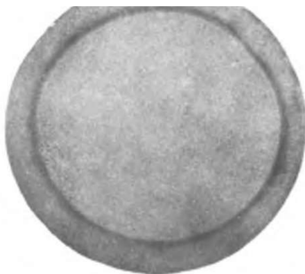
Рис. 7. Макроструктура шейки вала с поверхностной высокочастотной закалкой.
