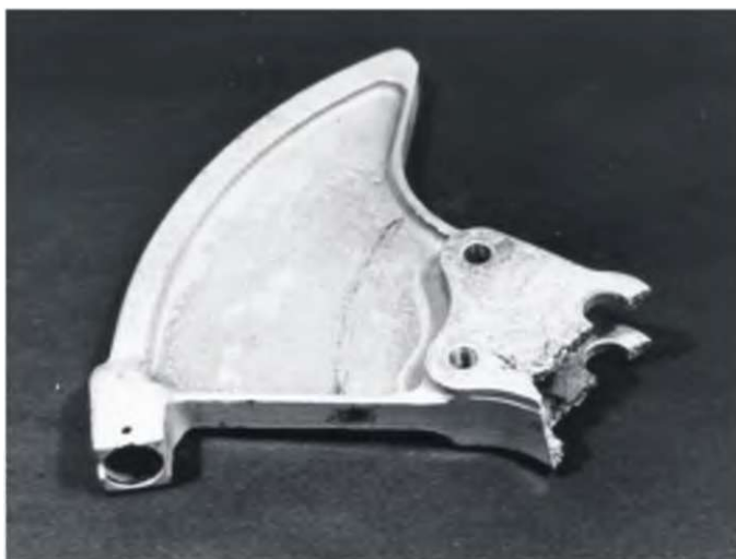
Рис. 9.12. Общий вид разрушенного сектора управления.
