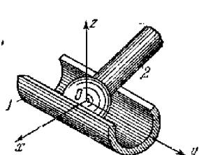
Определить класс кинематической пары, образованной звеньями 1 и 2. Указать, какие из шести независимых движений (трех поступательных и трех вращательных) одного звена относительно другого невозможны в кинематической паре.
