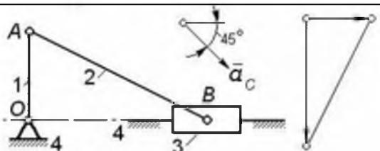
Кривошип  $OA$  механизма вращается равномерно; обозначить полюс и все векторы плана ускорений. Считая все постоянные размеры звеньев заданными, указать на прямой  $AB$  звена 2 такую точку  $C$ , ускорение которой  $\bar{\alpha}_c$  направлено, как показано на рисунке (написать формулу, по которой вычисляется положение этой точки на звене). Нанести соответствующую точку на план ускорений.
