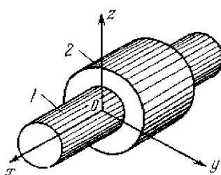
Определить класс кинематической пары, образованной звеньями 1 и 2, если оба звена, вошедшие в кинематическую пару, совершают плоскопараллельное движение, относительно плоскости Oyz.
