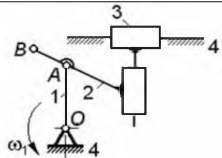
Определить скорость и ускорение точки  $B$  звена 2; указать направления обоих векторов для заданного положения механизма.
