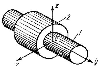
Определить класс кинематической пары, образованной звеньями 1 и 2, если оба звена, вошедшие в кинематическую пару, совершают плоскопараллельное движение, относительно плоскости Oyz.
