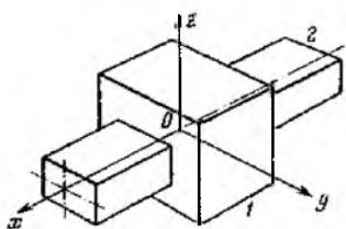
Определить класс кинематической пары, образованной звеньями 1 и 2. Указать, какие из шести независимых движений (трех поступательных и трех вращательных) одного звена относительно другого невозможны в кинематической паре.
