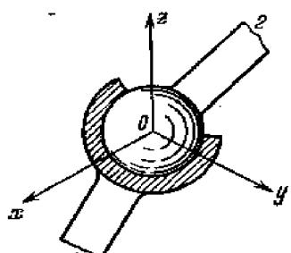
Определить класс кинематической пары, образованной звеньями 1 и 2. Указать, какие из шести независимых движений (трех поступательных и трех вращательных) одного звена относительно другого невозможны в кинематической паре.
