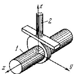
Определить класс кинематической пары, образованной звеньями 1 и 2, если оба звена, вошедшие в кинематическую пару, совершают плоскопараллельное движение, относительно плоскости Oyz.
