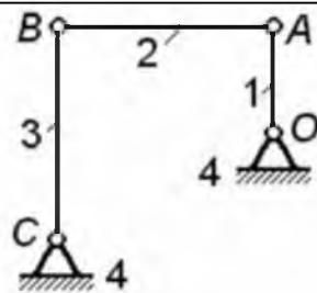
В рассматриваемом положении механизма звенья 1 и 3 вертикальны, звено 2 горизонтально. Звено 1 вращается равномерно с угловой скоростью  $\omega_1 = 10 \text{ рад / с}$ . Длины звеньев:  $AB = BC = 2OA$ . Найти величину и направление углового ускорения звена 2.
