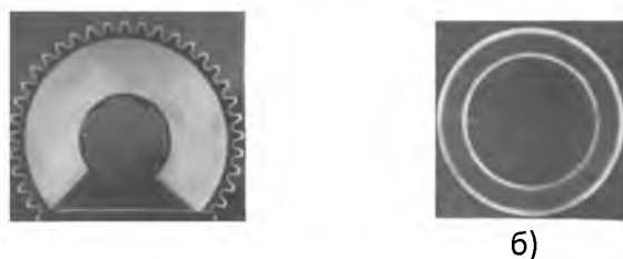
Рис. 5.7. Макроструктура стали 55ПШ для поверхностной высокочастотной закалки: а) макроструктура шестерни, закалённой с нагревом с помощью простого кольцевого индуктора; б) макроструктура трубчатой детали, закалённой с нагревом с помощью простого кольцевого индуктора.
