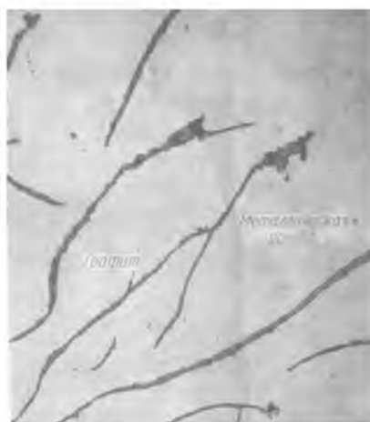
Рис. 31. Пластинчатый графит в серых чугунах. \times 200 .
