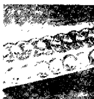
Рис. 5.12. Макроструктура «дорожки» после лазерной закалки стали.
