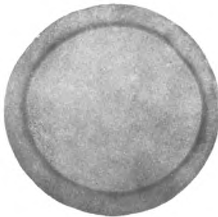
Рис. 7. Макроструктура шейки вала с поверхностной высокочастотной закалкой.
