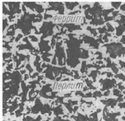
Рис. 25. Микроструктура стали с содержанием углерода 0,4%. \times 200 .
