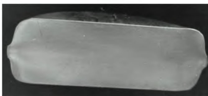
Рис. 13. Макроструктура штампованной поковки. Макроструктура удовлетворительная. Сплав на основе титана ВТ 22.
