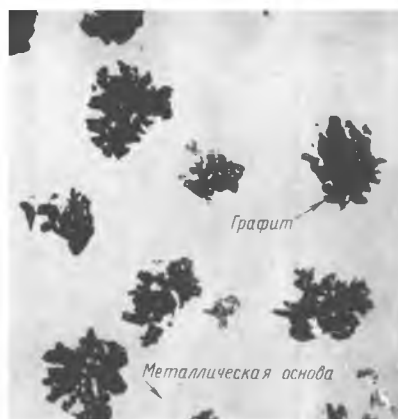
Рис. 33. Хлопьевидный графит в ковких чугунах. \times 200 .
