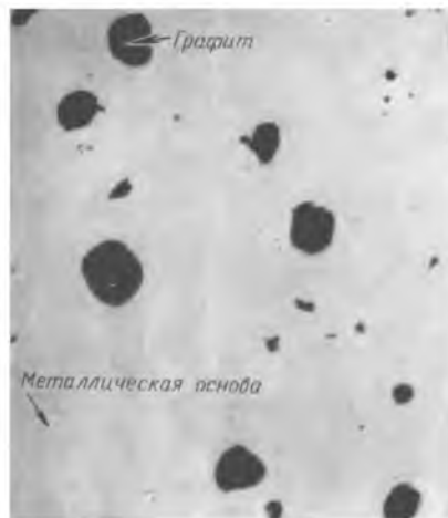
Рис. 32. Шаровидный графит в высокопрочных чугунах. \times 200 .
