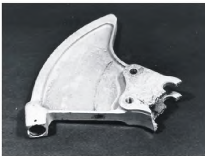
Рис. 9.12. Общий вид разрушенного сектора управления.
