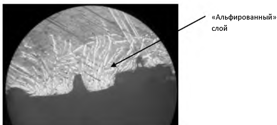
Рис. 30. «Альфированный» слой на поверхности титанового сплава. \times 200 .
