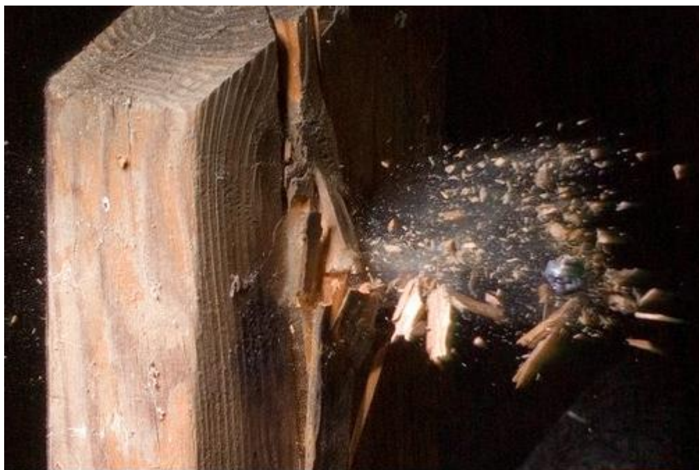
Рис. 2. Внешний вид повреждения в преграде
