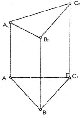
56) Дано: пл.  $\Gamma(a \parallel b)$   $A$  с  $\Gamma$ . Опред.  $\angle$  наклона пл.  $\Gamma$  к  $\Pi_2$  пользуясь линией наибольшего наклона
