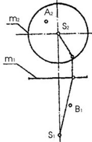
25) Дано: поверхн. тора и линия  $AB/A_2B_2$ , принадл. этой пов-ти. Построить профильн. проекц.  $AB$  Опр. вид.  $AB$
