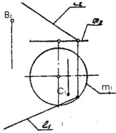
22) Дано: конич. пов.  $\Phi(m, S)$  и точки  $A(A_2)$ ,  $B(B_1)$ . Построить:  $A_1$  и  $B_2$  и горизонтальный контур.
