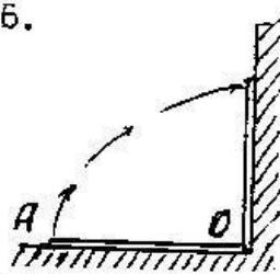
Определить работу, необходимую для того чтобы однородную доску длиной  $OA = 2 \text{ м}$  и весом  $G = 20 \text{ кг}$  прислонить вертикально к стене, повернув из горизонтального положения вокруг точки О. Принять  $g = 10 \text{ м/с}^2$ .
