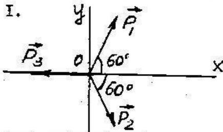
1. Определить равнодействующую плоской системы сходящихся сил  $\vec{P}_1$ ,  $\vec{P}_2$  и  $\vec{P}_3$  ( $P_1 = P_2 = P_3 = 100$  н).
