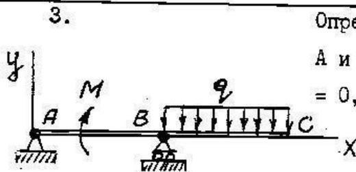
3. Определить реакции неподвижного шарнира A и подвижного шарнира B, если:  $AB = BC = 0,6$  м;  $q = 500$  нм  $M = 30$  нм.
