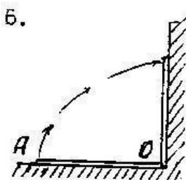
6. Определить работу, необходимую для того чтобы однородную доску длиной  $OA = 2$  м и весом  $G = 20$  кг прислонить вертикально к стене, повернув из горизонтального положения вокруг точки O. Принять  $g = 10$  м/с<sup>2</sup>.
