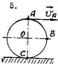
5. Колесо радиуса  $R$  катится без скольжения равномерно, причем скорость верхнего конца диаметра  $V_A = 2$  м/с. Зная положение мгновенного центра скоростей (точка C). Определить направление скорости точки B, а также величину и направление скорости точки O.
