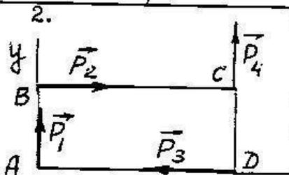
2. Определить главный момент системы сил  $\vec{P}_1$  ( $P_1 = 20$  н),  $\vec{P}_2$  ( $P_2 = 40$  н),  $\vec{P}_3$  (60 н) и  $\vec{P}_4$  ( $P_4 = 20$  н) относительно вершины A прямоугольника ABCD, где  $BC = 2 AB$ .
