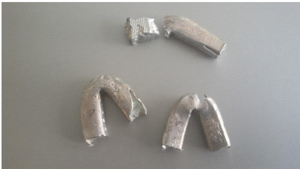
Рисунок 7 – Образцы стеклометаллокомпозитных стержней после испытаний на удар
