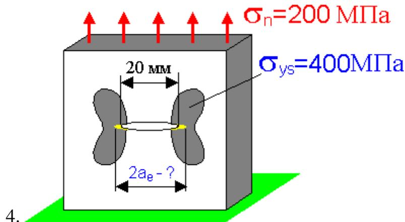
4. Коэффициент интенсивности напряжений для стальной пластины, нагруженной напряжением 110 МПа, равен  $19.5 \text{ МПа м}^{1/2}$ . Номинальное напряжение увеличивается в 2 раза. Какое значение имеет коэффициент интенсивности напряжений для эффективного размера трещины при пластических деформациях?
