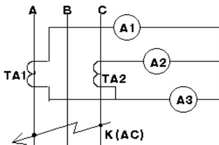
Ток двухфазного КЗ  $I_{\text{к}}(\text{AC}) = 1 \text{ кА}$ ,
