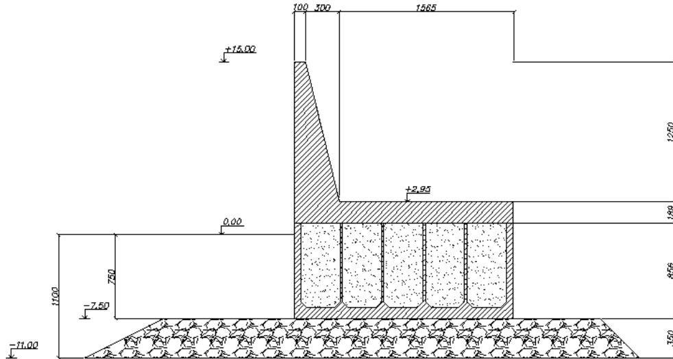
Рисунок 1. Поперечное сечение рассчитываемого сооружения, подобранное на основании статического расчёта.
