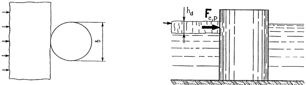
Рис.1. Схема приложения нагрузки от движущегося ледяного поля на отдельно стоящую вертикальную опору
