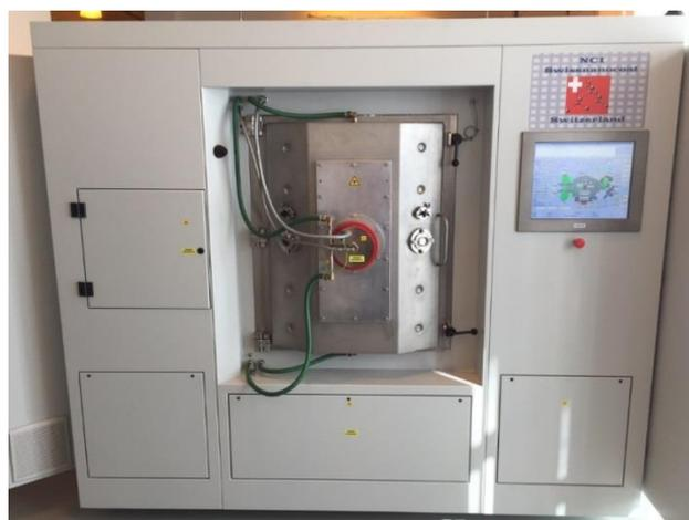
**Рисунок 7** – Установка SNC-500, установленная в ДВФУ, позволяет получать покрытия TiN, TiAlN, ta-C, ta-C:H и другие.
