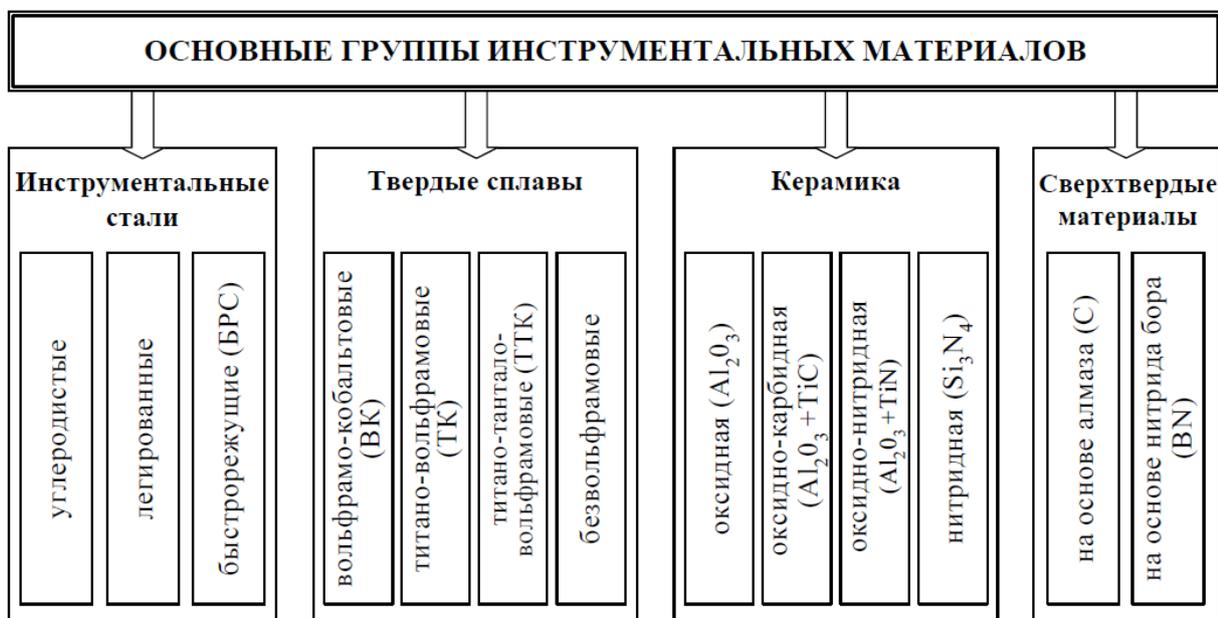
Рисунок 3 - Классификация инструментальных материалов.
