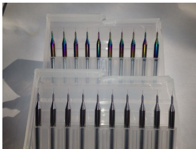
Рисунок 9 - Микросверла с ta:C покрытием (верхний ряд) и без покрытия (нижний ряд).
