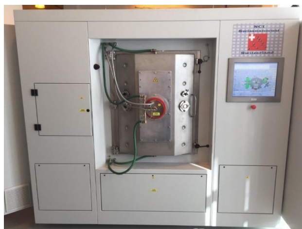
Рисунок 7 – Установка SNC-500, установленная в ДВФУ, позволяет получать покрытия TiN, TiAlN, ta-C, ta-C:H и другие.
