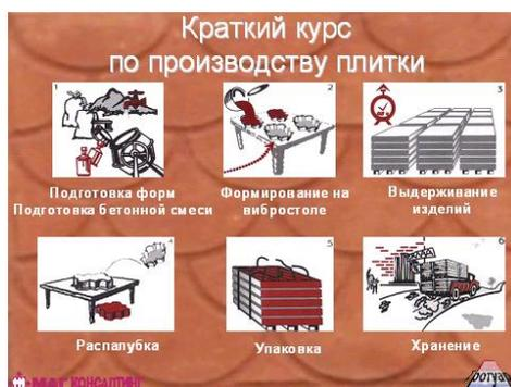
Рисунок: Как производится плитка
