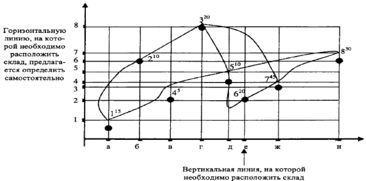
Рисунок 3 – Определение оптимального места расположения распределительного склада в условиях прямоугольной сети автомобильных дорог
