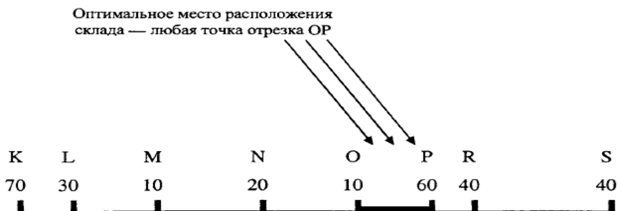
Рисунок 5 – Определение оптимального расположения склада при равенстве «левого» и «правого» грузооборотов пробной точки (числами указан грузооборот потребителей, т/мес.)
