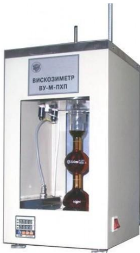
Рис. 2.1. Общий вид вискозиметра ВУ-М-ПХП
