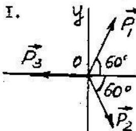
Определить равнодействующую плоской системы сходящихся сил  $\vec{P}_1$ ,  $\vec{P}_2$  и  $\vec{P}_3$  ( $P_1 = P_2 = P_3 = 100 \text{ н}$ ).
