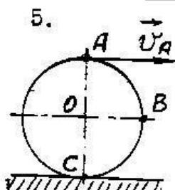
Колесо радиуса  $R$  катится без скольжения равномерно, причем скорость верхнего конца диаметра  $U_A = 2 \text{ м/с}$ . Зная положение мгновенного центра скоростей (точка С). Определить направление скорости точки В, а также величину и направление скорости точки О.
