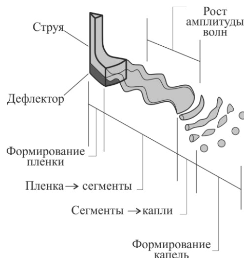
Рис. 1. Схема распада струи в спринклерном оросителе.
