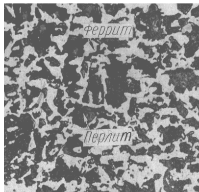
Рис. 25. Микроструктура стали с содержанием углерода 0,4%. \times 200 .
