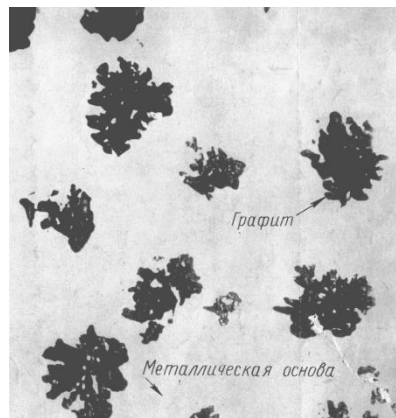
Рис. 33. Хлопьевидный графит в ковких чугунах. \times 200 .
