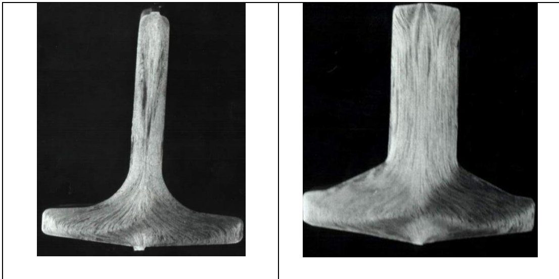
Рис. 9 . Макроструктура штампованных поковок. Макроструктура удовлетворительная. Сплав АК6.
