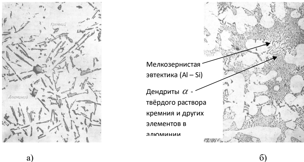
Рис. 34. Микроструктура силумина: а) до модифицирования; б) после модифицирования. ×200
