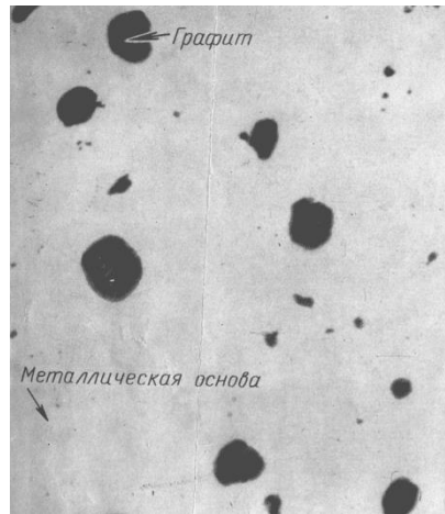
Рис. 32. Шаровидный графит в высокопрочных чугунах. \times 200 .
