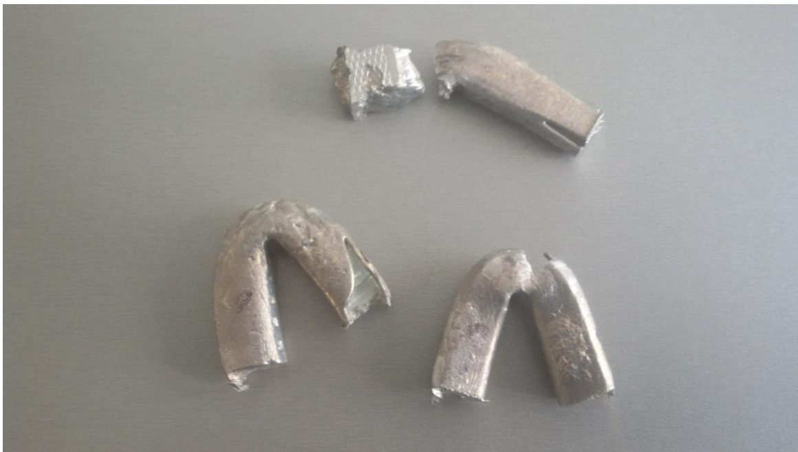
Рисунок 7 – Образцы стеклометаллокомпозитных стержней после испытаний на удар
