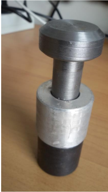
Рисунок 5 – Образец стекломаталлокомпозита перед сдвиговыми испытаниями
