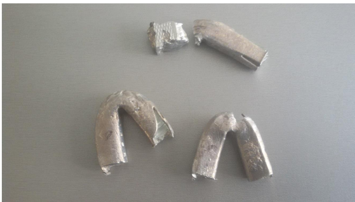
Рисунок 7 – Образцы стеклометаллокомпозитных стержней после испытаний на удар
