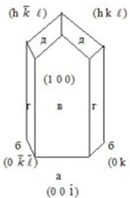
6.  $\alpha = \beta = \gamma = 90^\circ$ ;  $a_0 \neq b_0 \neq c_0$ ;  $a : 1 : c$ .
