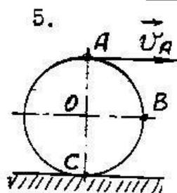
Колесо радиуса  $R$  катится без скольжения равномерно, причем скорость верхнего конца диаметра  $U_A = 2$  м/с. Зная положение мгновенного центра скоростей (точка C). Определить направление скорости точки B, а также величину и направление скорости точки O.
