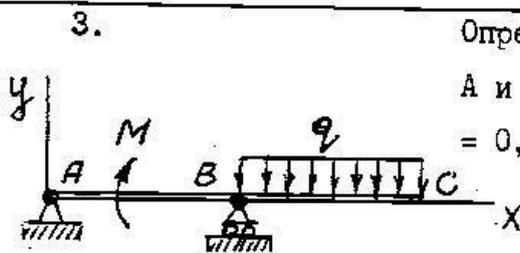
Определить реакции неподвижного шарнира A и подвижного шарнира B, если:  $AB = BC = 0,6$  м;  $q = 500$  нм  $M = 30$  нм.
