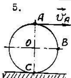
Колесо радиуса  $R$  катится без скольжения равномерно, причем скорость верхнего конца диаметра  $v_A = 2 \text{ м/с}$ . Зная положение мгновенного центра скоростей (точка С). Определить направление скорости точки В, а также величину и направление скорости точки О.
