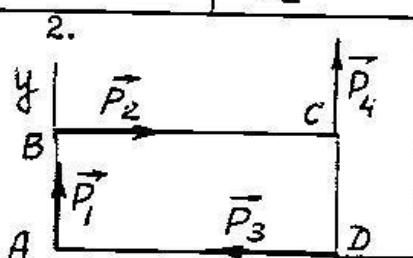
Определить главный момент системы сил  $\vec{P}_1$  ( $P_1 = 20 \text{ н}$ ),  $\vec{P}_2$  ( $P_2 = 40 \text{ н}$ ),  $\vec{P}_3$  ( $P_3 = 60 \text{ н}$ ) и  $\vec{P}_4$  ( $P_4 = 20 \text{ н}$ ) относительно вершины A прямоугольника ABCD, где  $BC = 2 AB$ .
