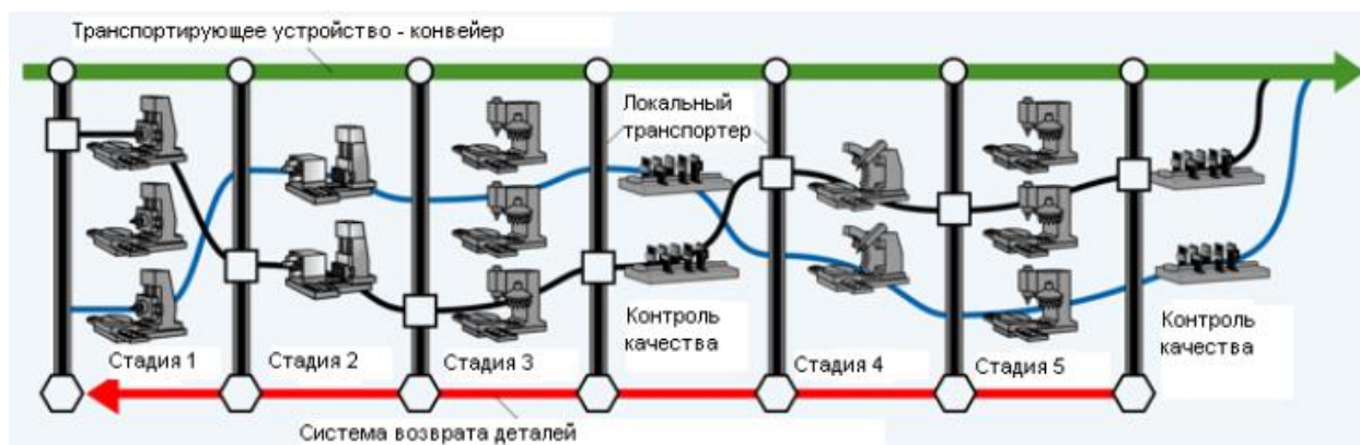
Рис. 3. Сетевая топология поточного реконфигурируемого производства
