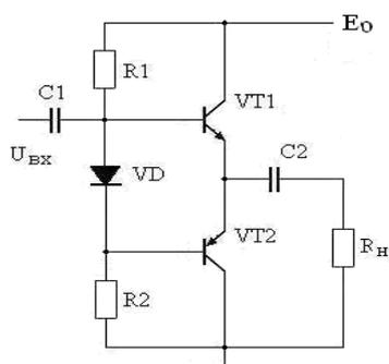
Рис.2. Усилитель мощности
