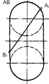
23) Дано: сфера. Построить  $A_2, B_2$  принадл. поверхности, определить видимость AB
