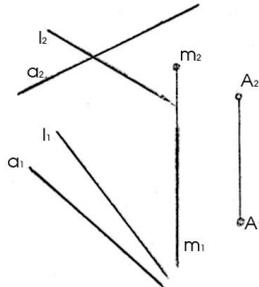
31) Дано:  $\Gamma(ABCD)$ ,  $a(a_1, a_2)$ . Построить:  $K = \Gamma \cap a$ . Опр. видимость "а"
