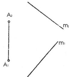
37) Дано:  $\Gamma(ABC)$  и  $m(m_1, m_2)$ . Построить пл.  $\Sigma \perp \Gamma$  и проход. через прямую  $m$ .
