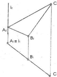
54) Дано:  $a(a_1, a_2)$  и  $b(b_1, b_2)$ . Определ. угол между  $a$  и  $b$ .
