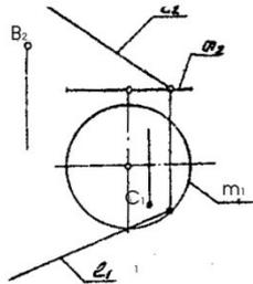
22) Дано: конич. пов.  $\Phi$  (m, S) и точки  $A(A_2), B(B_1)$ . Построить:  $A_1$  и  $B_2$  и горизонтальный контур.
