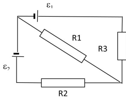
33. Найти силу тока во всех участках цепи  $I_1, I_2, I_3$  ампер. При этом известны следующие величины: ЭДС<sub>1</sub> В, ЭДС<sub>2</sub> В, R<sub>1</sub> Ом, R<sub>2</sub> Ом, R<sub>3</sub> Ом. Внутреннее сопротивление элементов равно нулю.
