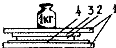
Рисунок 1 - Определение ВУС методом прессования 1 – Плексигласовая пластинка; 2 – Навеска фарша; 3 – Полиэтиленовый кружок; 4 – Фильтр.
