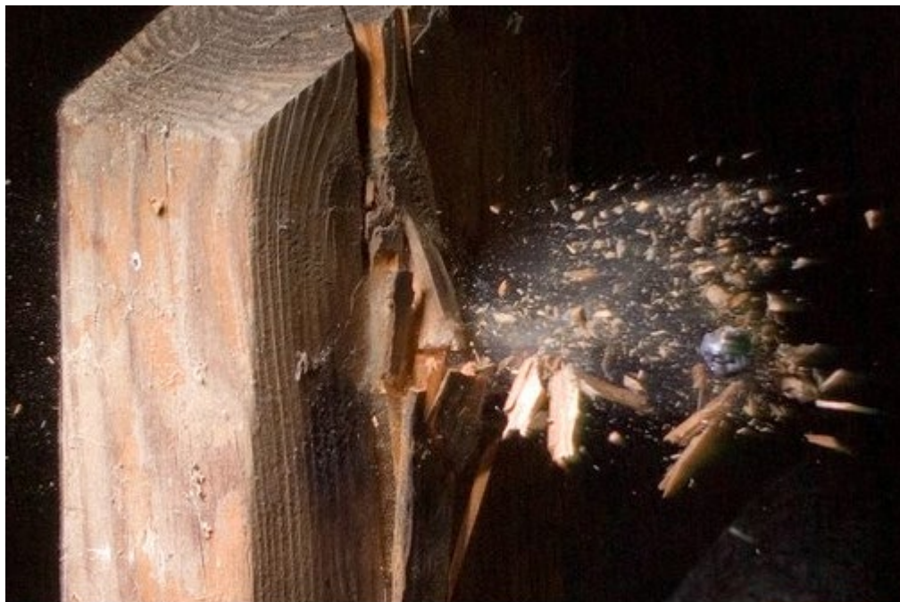
Рис. 2. Внешний вид повреждения в преграде
