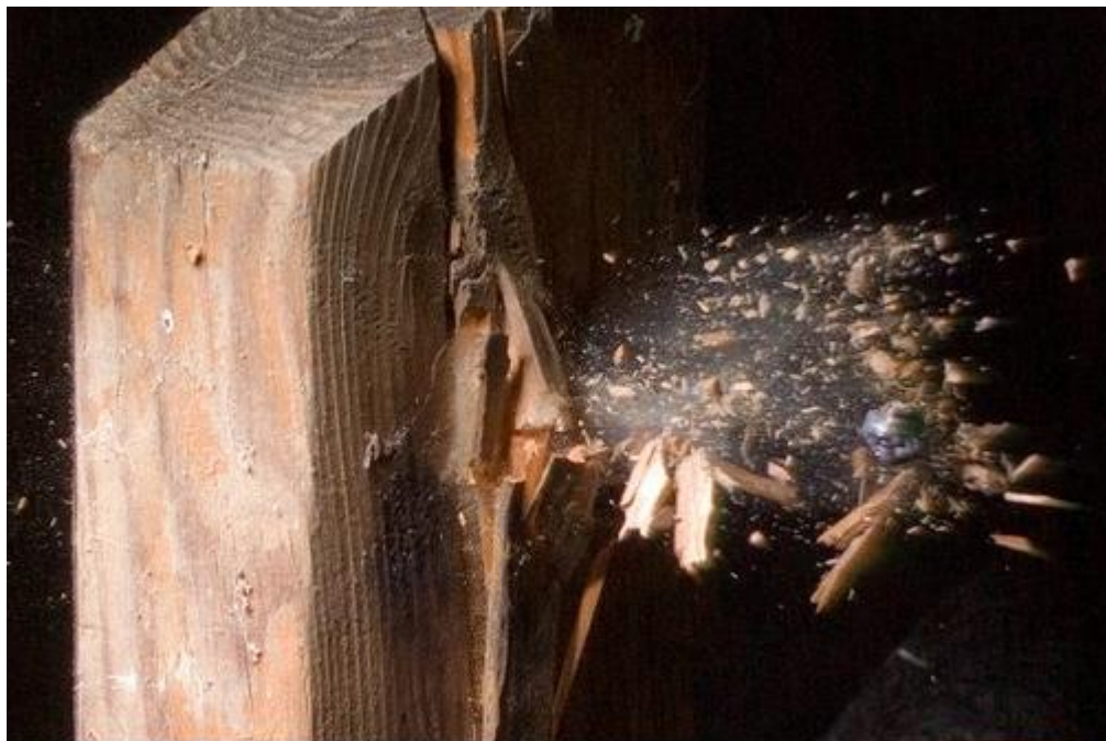
Рис. 2. Внешний вид повреждения в преграде
