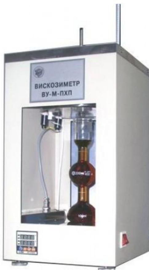
Рис. 2.1. Общий вид вискозиметра ВУ-М-ПХП
