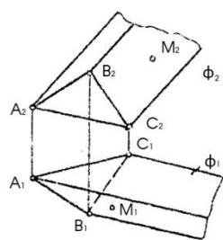
22) Дано: конич. пов.  $\phi$  ( $m, S$ ) и точки  $A(A_2), B(B_1)$ . Построить:  $A_1$  и  $B_2$  и горизонтальный контур.
