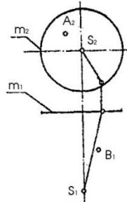
23) Дано: сфера. Построить  $A_2B_2$  принадл. поверхности, определить видимость AB
