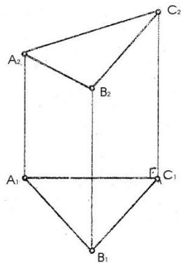
56) Дано: пл.  $\Gamma(a \parallel b)$  А с  $\Gamma$ . Опред.  $\angle$  наклона пл.  $\Gamma$  к  $\Pi_2$  пользуясь линией наибольшего наклона
