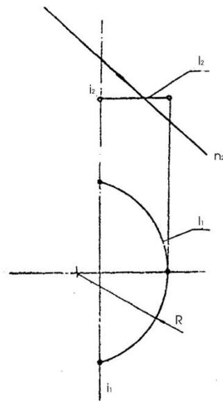
29) Дано: пл.  $\Sigma (\Sigma_2)$ ,  $m(m_1, m_2)$ ,  $l(l_1, l_2)$ . Построить точки  $\bar{k} = \Sigma \cap m$ ,  $\bar{l} = \Sigma \cap l$ .
