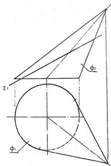
62) Дано: поверхн. цилиндра вращения  $\phi$  и пл.  $\Gamma(a \parallel b)$ . Построить линию взаимного пересечения.
