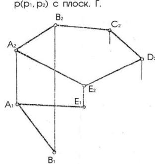
20) Построить пл.  $\Gamma \perp \Pi_2$  под  $\angle 30^\circ$  к  $\Pi_1$
