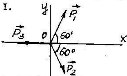
Определить равнодействующую плоской системы сходящихся сил  $\vec{P}_1$ ,  $\vec{P}_2$  и  $\vec{P}_3$  ( $P_1 = P_2 = P_3 = 100 \text{ н}$ ).
