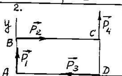
Определить главный момент системы сил  $\vec{P}_1$  ( $P_1 = 20 \text{ н}$ ),  $\vec{P}_2$  ( $P_2 = 40 \text{ н}$ ),  $\vec{P}_3$  ( $P_3 = 60 \text{ н}$ ) и  $\vec{P}_4$  ( $P_4 = 20 \text{ н}$ ) относительно вершины A прямоугольника ABCD, где  $BC = 2 AB$ .
