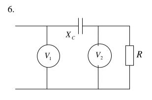
Напряжение U в сети изменяется по закону, график которого представлен на рисунке. Определить показания вольтметров при условии, что  $X_{\mathcal{C}}$  << R . Вольтметр  $V_{1}$  - электродинамической системы, вольтметр
