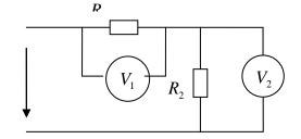
Два сопротивления  $R_1$  и  $R_2$  включены последовательно. Показания вольтметров  $U_1$ = 120 В,  $U_2$ = 75 В. Для измерения напряжений ис-пользовались вольтметры:  $V_1$ - номинальное напряжение 150 В, класс точности 1,0;  $V_2$ -номинальное напряжение 100 В, класс точности 1,5. Определить максимальную относительную погрешность измерения напряжения U.
