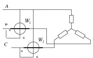
Активная мощность симметричной трёхфазной цепи с линейным напряжением  $U_{\pi} = 380$  В измерена методом двух ваттметров (ваттметры одинаковые). Показания ваттметров в делениях шкалы  $\alpha_1 = 30$  дел.,  $\alpha_2 = -10$  дел. Линейный ток  $I_{\pi} = 10$  А. Вычислить реактивную мощность цепи.
