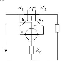
Номинальные данные ваттметра:  $I_H = 5 \, \mathrm{A}$ ,  $U_H = 150 \, \mathrm{B}$ . Максимальное число делений шкалы  $\alpha_m = 150 \, \mathrm{дел}$ . Сопротивление параллельной цепи  $\mathrm{Rv} = 5 \, \mathrm{кОм}$ . Для расширения предела измерения по току включён измерительный трансформатор тока со следующими номинальными данными:  $I_{1H} = 15 \, \mathrm{A}$ ,
