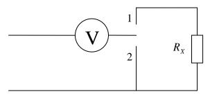
Для измерения сопротивления использован вольтметр с внутренним сопротивлением  $R_V = 50$  кОм. При последователь-ном его включении с измеряемым сопротивлением (положение 1 ключа) прибор показал 100 В, а при его подключении без сопротивления (положение 2 ключа) - 120 В. Определить сопротивление  $R_X$  и наибольшую относительную погрешность измерения, если вольтметр имеет предел измерения
