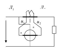
Номинальные данные ваттметра:  $I_H$  = 5 A,  $U_H$  = 150 В. Максимальное число делений шкалы  $\alpha_m$  = 150 дел. Для расширения предела измерения по току включён измерительный трансформатор тока со следующими номинальными данными:  $I_{1H}$  = 50 A,  $I_{2H}$  = 5 A. По шкале ваттметра зарегистрировано  $\alpha$  = 100 дел. Определить мощность нагрузки.
