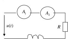
Определить показания магнитоэлектрического  $(A_1)$  и электромагнитного  $(A_2)$ амперметров, если напряжение изменяется по закону  $u(t) = 100 + 50 \sin \omega \cdot t$ . Параметры цепи R = 10 Ом,  $X_L = 10$  Ом.
