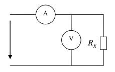
имеет падение напряжения  $U_v$  =75 мВ. Ток полного отклонения вольтметра при  $U_H$  = 150 В равен  $I_V$  = 7,5 мА. Определить относительную погрешность измерения сопротивления  $R_X$  .
