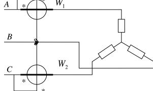
Определить величину и знак угла  $\varphi$  симметричной трёхфазной цепи, если при включении двух однофазных ваттметров для измерения активной мощности первый показал  $P_1$  = 0 Вт, а второй  $P_2$  = 500 Вт.
