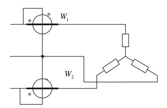
Линейный ток  $I_{\pi}$  =20 А. Вычислить реактивную мощность цепи.
