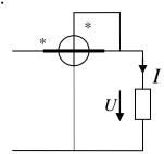
Для измерения мощности постоянных тока использован ваттметр с верхними пределами измерения: по току  $u_1 = 5$  A, по напряжению  $U_H = 150$  B. Сопротивление последовательной цепи  $R_A = 0,2$  Ом, сопротивление параллельной цепи  $R_V = 5$  кОм. Чему равна относительная погрешность измерения мощности, если ток нагрузки I = 2 A, а напряжение U = 100 B.
