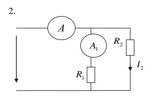
Два сопротивления  $R_1$  и  $R_2$  включены параллельно. Показания амперметров I=8 А,  $I_1=6$  А. Для измерения токов использовались амперметры: A номинальный ток 10 А, класс точности  $0,5; A_1$  -номинальный ток 10 А, класс точности 1,0. Определить максимальную относительную погрешность измерения тока  $I_2$ .
