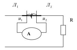
Амперметр включён с измерительным трансформатором тока. Определить ток нагрузки и максимальную относительную погрешность измерения. Исходные данные: показание амперметра в делениях шкалы  $\alpha$  =100 дел.; максимальное число делений шкалы  $\alpha_m$ =150 дел.; номинальное значение тока амперметра  $I_H$  = 10 A; класс точности амперметра 1,0; коэффициент трансформации K = 3; класс точности измерительного трансформатора тока 0,2.
