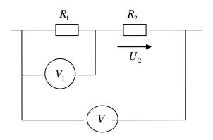
Два сопротивления  $R_1$  и  $R_2$  включены последовательно. Показания вольтметров  $U=100\,$  В,  $U_1=50\,$  В. Для измерения напряжений использовались вольтметры: V - номинальное напряжение 150 В, класс точности 0,5;  $V_1$  - номинальное напряжение 75 В, класс точности 1,0. Определить максимальную относительную погрешность
