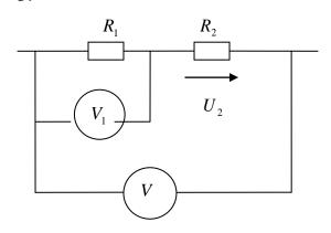
Два сопротивления  $R_1$  и  $R_2$  включены последовательно. Показания вольтметров U =100 B,  $U_1$  =75 B. Для измерения напряжений использовались вольтметры: V - номинальное напряжение 150 B, класс точности 1,0/0,5;  $V_1$  - номинальное напряжение 100 B, класс точности 1,0. Определить максимальную относительную погрешность измерения напряжения  $U_2$ .
