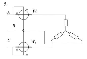
В цепи трехфазного тока мощность измеряется по схеме двух ваттметров, нагрузка фаз симметричная.
