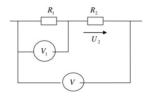
Два сопротивления  $R_1$  и  $R_2$  включепоследовательно. НЫ Показания вольтметров U = 100 B,  $U_1 = 75 \text{ B}$ . напряжений Ис-Для измерения пользовались вольтметры: V - номинальное напряжение 150 В, класс точности  $0,5; V_1$  - номинальное напряжение 100 В, класс точности 0,5. Определить максимальную относительную погрешность измерения напряжения  $U_2$ .
