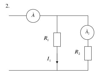
Два сопротивления  $R_1$  и  $R_2$  включены параллельно. Показания амперметров I=2 А,  $I_2=1,4$  А. Для измерения токов использовались амперметры: A - номинальный ток 2,5 А, класс точности 0,5 ;  $A_2$  - номинальный ток 2,0 А, класс точности 1,0. Определить максимальную относительную погрешность измерения тока  $I_1$ .
