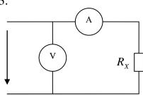
Для измерения неизвестного сопротивления  $R_{\scriptscriptstyle X}$  были проведены следующие измерения. Показания приборов  $I=8\,$  A,  $U=80\,$  B. Амперметр при номинальном токе  $I_H = 10$  A, имеет падение напряжения $U_{v}$ =75 мВ. Ток полного отклонения вольтметра при  $U_{\scriptscriptstyle H}$ = 150 В равен  $I_V$  = 7,5 мА. Определить относительную погрешность измерения сопротивления  $R_{\chi}$ .
