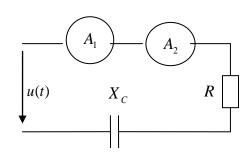
Определить показания магнитоэлектрического  $(A_1)$  и электродинамического  $(A_2)$  амперметров, если напряжение изменяется по закону  $u(t) = 200 + 100 \sin \omega t$ . Параметры цепи R = 10 Ом,  $X_C = 10$  Ом.
