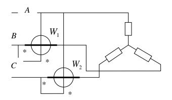
Определить величину и знак угла  $\varphi$  симметричной трёхфазной цепи, если при включении двух однофазных ваттметров для измерения активной мощности первый показал  $P_1 = 600$  Вт, а второй  $P_2 = 100$  Вт.
