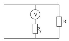
Чему равно добавочное сопротивление вольтметра  $R_g$ , если сопротивление вольтметра  $R_v$  = 10 кОм, номинальное значение  $U_H$  = 100 B, а напряжение нагрузки
