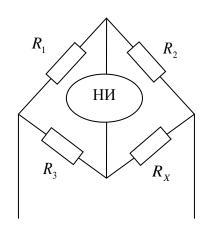
Определить сопротивление резистора  $R_X$  , если мост уравновешен при  $R_1$  = 125 Ом,  $R_2$  = 250 Ом,  $R_3$  = 75 Ом.
