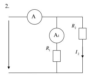
Два сопротивления  $R_1$  и  $R_2$  включены параллельно. Показания амперметров I=20 А,  $I_1=8$  А. Для измерения токов использовались амперметры: A - номинальный ток 25 А, класс точности 1,5/1,0 ,  $A_1$  - номинальный ток 10 А, класс точности 1,0. Определить максимальную относительную погрешность измерения тока  $I_2$ .
