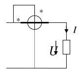
Для измерения мощности постоянных тока использован ваттметр с верхними пределами измерения: по току  $I_H = 1$  A, по напряжению  $U_H = 150$  B. Сопротивление последовательной цепи  $R_A = 0.2$  Ом, сопротивление параллельной цепи  $R_V = 5$  кОм. Чему равна относительная погрешность измерения мощности, если ток нагрузки I = 1 A, а напряжение U = 100 B.
