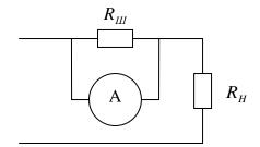
Амперметр включён с шунтом. Определить ток нагрузки и максимальную относительную погрешность измерения. Исходные данные: показание амперметра в делениях шкалы  $\alpha=80$  дел.; максимальное число делений шкалы  $\alpha_m=100$  дел.; номинальное значение тока амперметра без шунта  $I_H=10$  А; класс точности амперметра 0,5; коэффициент расширения предела измерения n=10; класс точности шунта 0,2.
