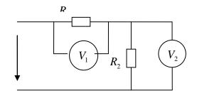
Два сопротивления  $R_1$  и  $R_2$  включены последовательно. Показания вольтметров  $U_1$ = 100 В, $U_2$ = 50 В. Для измерения напряжений использовались вольтметры:  $V_1$  - номинальное напряжение 150 В, класс точности 0,2;  $V_2$  - номинальное напряжение 50 В, класс точности 1,0. Определить максимальную относительную погрешность измерения напряжения U.
