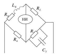
Определить значение индуктивности  $L_X$  и сопротивление  $R_X$  в цепи уравновешенного моста, если  $R_2$ = 100 Ом,  $R_3$  = 1000 Ом,  $C_3$ = 1 мкФ,  $R_4$ = 100 Ом.
