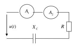
Определить показания магнитоэлектрического (  $A_1$  ) и электромагнитного (  $A_2$  ) амперметров, если напряжение изменяется по закону  $u(t) = 100 + 50 \sin \omega \cdot t$  . Параметры цепи R = 10 Ом,  $X_C = 10$  Ом.
