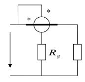
Номинальные данные ваттметра:  $I_H = 5$  A,  $U_H = 150$  В. Максимальное число делений шкалы  $\alpha_m = 150$  дел. Сопротивление параллельной цепи Rv = 5 кОм. Для расширения предела измерения по напряжению включён добавочный резистор  $R_g = 10$  кОм. По шкале ваттметра зарегистрировано  $\alpha = 100$  дел. Определить мощность нагрузки.
