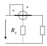
Ваттметр включён с добавочным резистором  $R_g$ . Определить мощность нагрузки и максимальную относительную погрешность измерения. Исходные данные: показание ваттметра в делениях шкалы  $\alpha=100$  дел.; максимальное число делений шкалы  $\alpha_m=150$  дел.; номинальное значение напряжения и тока ваттметра  $U_H$  =300 B,  $I_H=5$  A; класс точности ваттметра 1,0; коэффициент расширения предела измерения n=4; класс точности добавочного резистора 0,5.
