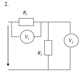
Два сопротивления  $R_1$  и  $R_2$  включены последовательно. Показания вольтметров  $U_1$ = 140 В,  $U_2$ = 80 В. Для измерения напряжений использовались вольтметры:  $V_1$  номинальное напряжение 150 В, класс точности 1,0;  $V_2$  - номинальное напряжение 100 В, класс точности 1,5/1,0. Определить максимальную относительную погрешность измерения напряжения U.
