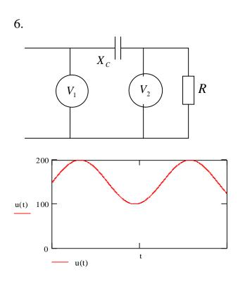
Напряжение U в сети изменяется по закону, график которого представлен на рисунке. Определить показания вольтметров при условии, что  $X_C << R$ . Вольтметр  $V_1$  - магнитоэлектрической системы, вольтметр
