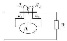
Определить ток нагрузки, если показание амперметра  $I_A = 4$  А. Номинальный ток первичной обмотки трансформатора тока  $I_{1H} = 15$  А, номинальный ток вторичной обмотки трансформатора тока  $I_{2H} = 5$  А.
