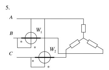
В цепи трехфазного тока мощность измеряется по схеме двух ваттметров, нагрузка фаз симметричная. Линейный ток  $I_{\it II} = 20$  A, линейное напряжение  $U_{\it II} = 380$  B, мощность системы P = 11400 BT. Определить показания ваттметров.
