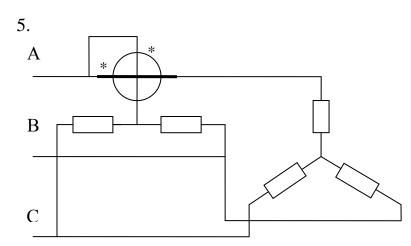
В симметричной трёхфазной цепи для измерения активной мощности применён ваттметр с искусственной нулевой точкой. Линейное напряжение  $U_{\pi} = 380$  В, сопротивление  $Z_a = Z_b = Z_c = 44 + \mathrm{j}33$  Ом. Определить показания ваттметров.
