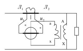
Номинальные данные ваттметра: Ін = 5 A, Uн = 300 B. Максимальное число делений шкалы  $\alpha_m = 150$  дел. Для расширения предела измерения по току включён измерительный трансформатор тока со следующими номинальными данными:  $I_{1H} = 50 \text{ A}$ ,  $I_{2H} = 5 \text{ A}$ . Для расширения предела измерения по напряжению включён измерительный трансформатор напряжения со следующими номинальными данными:  $U_{1H} = 380 \text{ B}$ ,  $U_{2H} = 100 \text{ B}$ .
