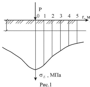
4.2. На поверхность массива грунта приложена сосредоточенная сила  $P$ . Определить значения вертикальных сжимающих напряжений  $\sigma_z$  в точках, расположенных по вертикальной оси на глубине  $z=1,2,3,4$  и  $5$  м от поверхности грунта и удаленных от линии действия силы  $P$  на расстояние  $r$ . Построить эпюру этих напряжений (рис. 2).
