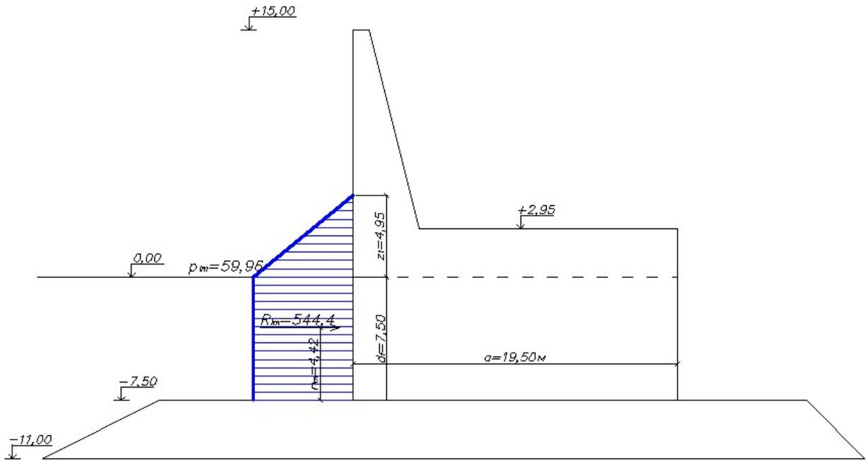
Рисунок 1. Эпюра импульса давлений в момент удара волны.
