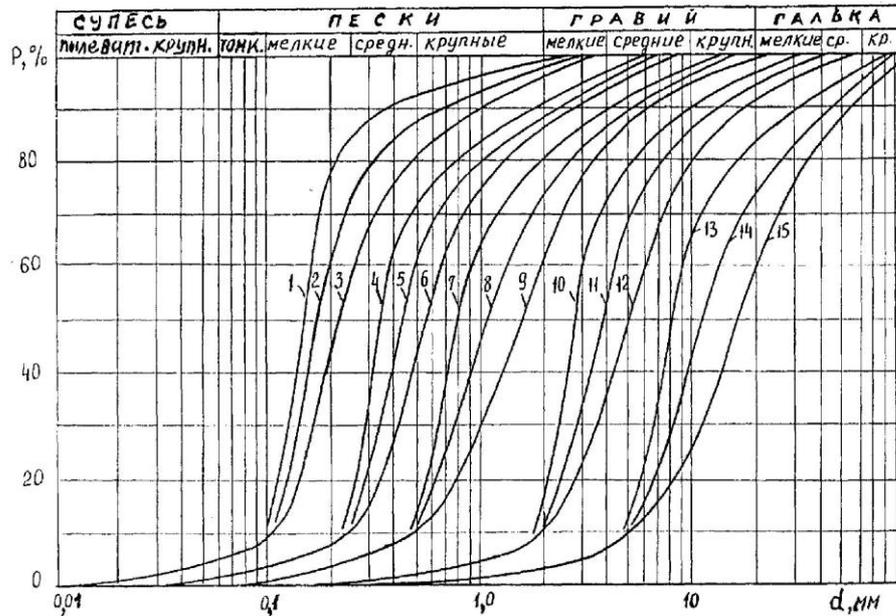
Рисунок 1- Интегральные кривые гранулометрического состава пород водоносных пластов
