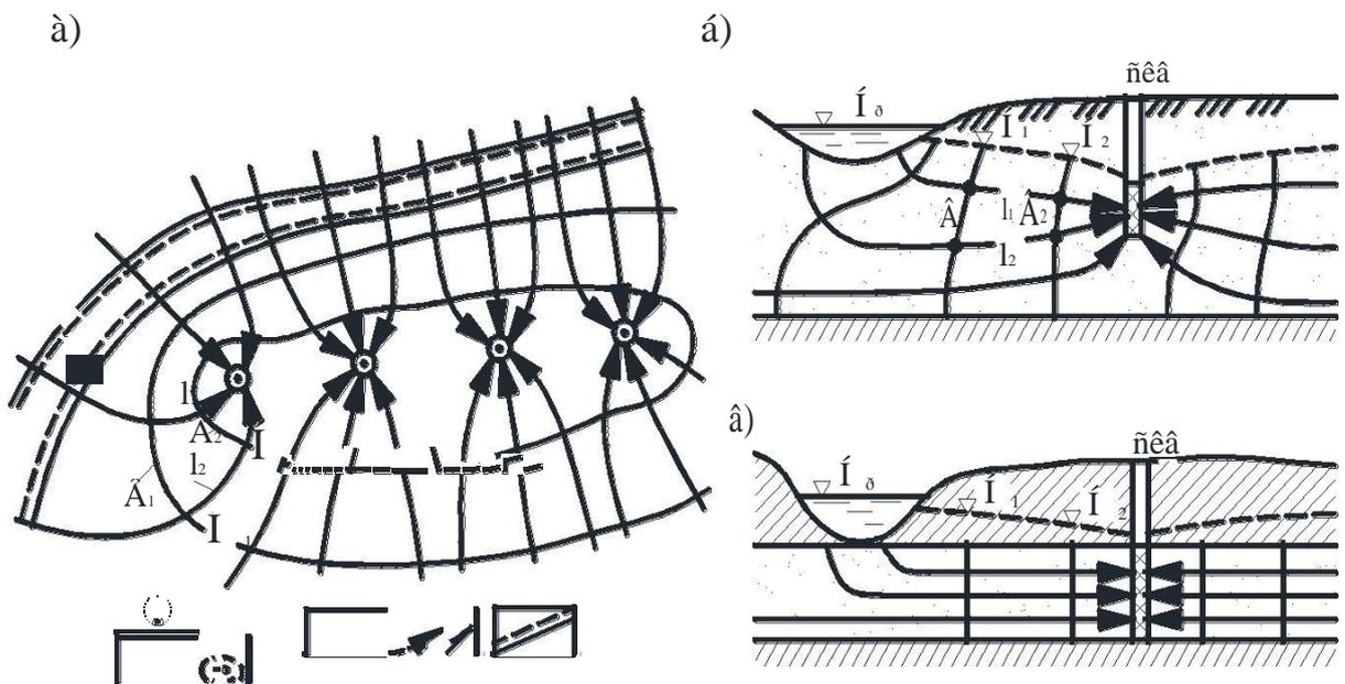
Рис. 1.2. Пространственная структура потока а – план потока; б, в – разрез
