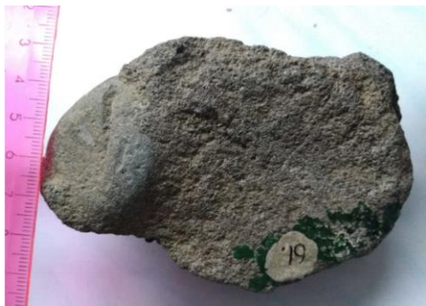
Рис. 6 Массивная текстура конгломерата
