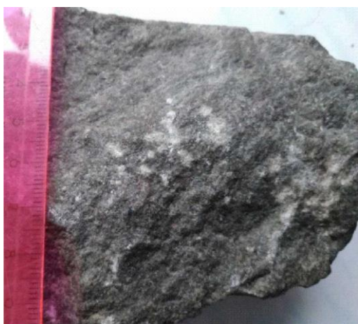
Рис. 1 Массивная текстура песчаника
