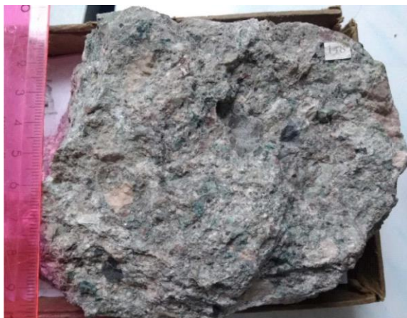
Рис. 8 Массивная текстура эруптивной брекчии
