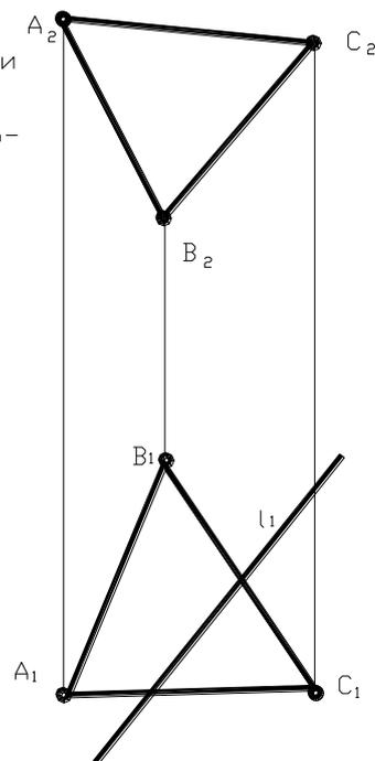
**ЗАДАЧА 5:** Определить точки пересечения прямой (К, М) с поверхностью. Определить величину отрезка КМ (отрезок внутри пирамиды).
