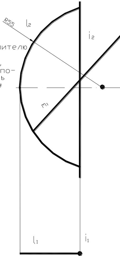
**ЗАДАЧА 2:** Построить проекции и натуральный вид сечения поверхности плоскостью.
