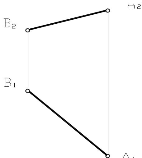
**Задача 6.** Построить точку В симметричную данной точке А, относительно прямой  $\theta$ . Определить расстояние от точки до прямой. Написать алгоритм решения задачи.
