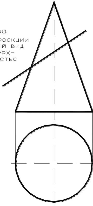
**ЗАДАЧА 4:** Построить проекции линии пересечения плоскостей.
