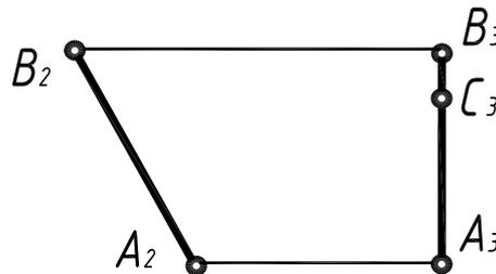
**Задача 3.** Дано: комплексный двухпроекционный чертёж отрезка АВ прямой; проекции точек С, D, Е. Определить взаимное положение точки и прямой, построить недостающие проекции прямой, написать название прямой.
