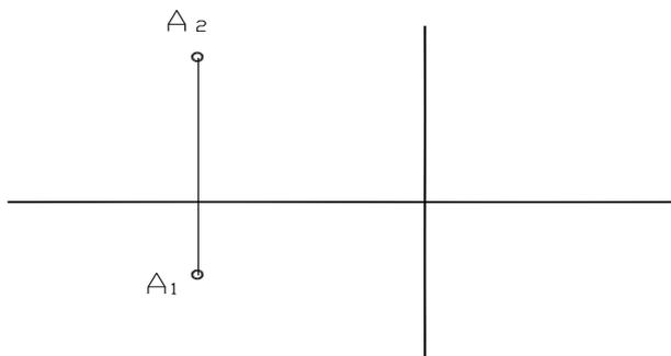
**Задача 5.** Определить натуральную величину отрезка  $AB$  и угол наклона к фронтальной плоскости проекций. Написать алгоритм решения задачи.
