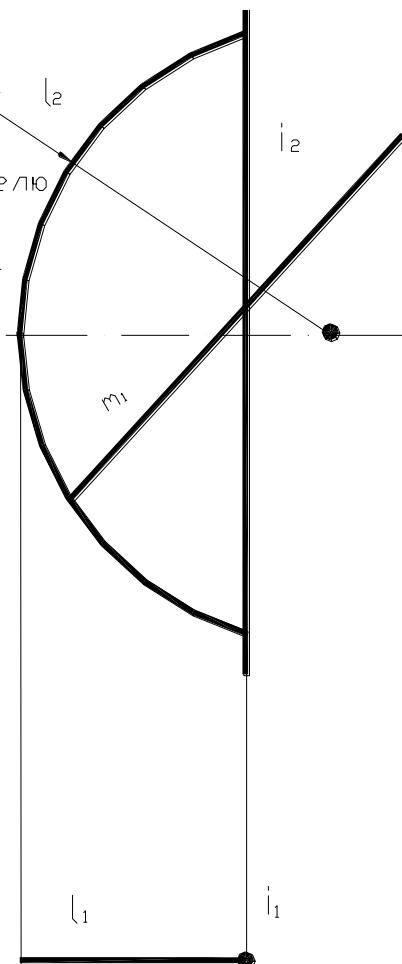
**ЗАДАЧА 2:** Построить проекции и натуральный вид сечения поверхности плоскостью.
