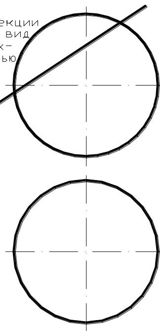
**ЗАДАЧА 3:** Построить проекции и натуральный вид сечения поверхности плоскостью.
