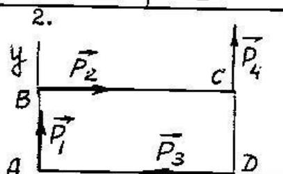
Определить главный момент системы сил  $\vec{P}_1$  ( $P_1 = 20 \text{ Н}$ ),  $\vec{P}_2$  ( $P_2 = 40 \text{ Н}$ ),  $\vec{P}_3$  ( $P_3 = 60 \text{ Н}$ ) и  $\vec{P}_4$  ( $P_4 = 20 \text{ Н}$ ) относительно вершины А прямоугольника АВСД, где  $BC = 2 AB$ .
