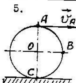
Колесо радиуса Р катится без скольжения равномерно, причем скорость верхнего конца диаметра  $v_A = 2 \text{ м/с}$ . Зная положение мгновенного центра скоростей (точка С). Определить направление скорости точки В, а также величину и направление скорости точки О.
