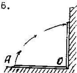
Определить работу, необходимую для того чтобы однородную доску длиной  $OA = 2 \text{ м}$  и весом  $G = 20 \text{ кг}$  прислонить вертикально к стене, повернув из горизонтального положения вокруг точки О. Принять  $g = 10 \text{ м/с}^2$ .
