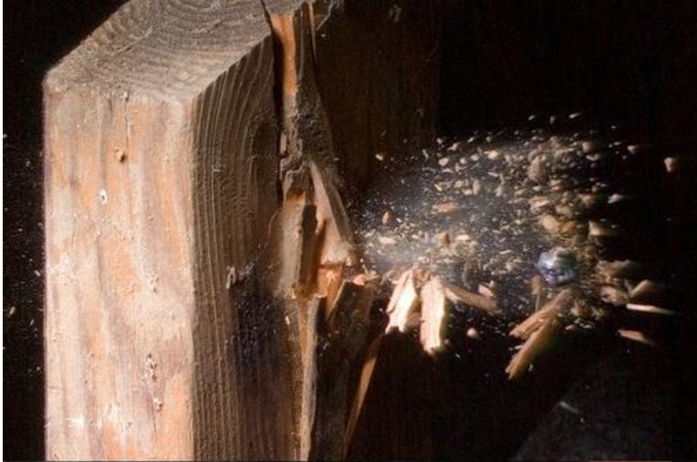
Рис. 2. Внешний вид повреждения в преграде
